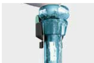
Sobald der Becher sitzt, erfolgt die Zitzenreinigung bzw. das Pre-Dippen, gefolgt von Trocknen & Vormelkprozess.
