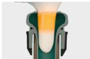
Erreicht der Milchfluss im Euterviertel den definierten Schwellenwert, wird die entsprechende Zitze gedippt. So verlässt die Kuh optimal geschützt den Melkstand.
