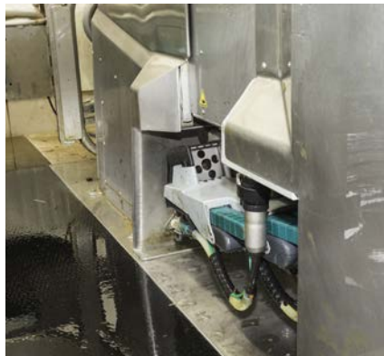
Nach dem Melken und während der chemischen Anlagenreinigung parkt der Roboterarm mit der darauf aufgebauten Kamera im Melkplatzmodul.
