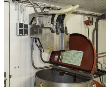
Die MS1 (Option) separiert und sammelt in einem bereitstehenden Tank die Milch für die Kälber.
