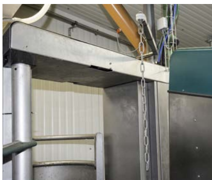
Damit kein Tier in der Melkbox Pause macht, erfolgt der Austrieb bei Bedarf mit einem kleinen Stromkitzel aus einem Weidezaungerät.
