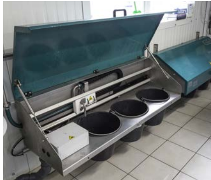
Die an der Seitenwand montierte Milchseparation MS20 fängt Kolostrum gezielt in Eimern auf.
