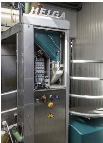
Die Monobox kann den Kühen mit Anrecht bis zu drei Kraftfuttersorten sowie über „Propy-Dos“ eine flüssige Komponente verabreichen.
