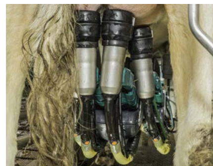
Die Melkbecher reinigen, stimulieren, melken und dicken die Zitzen. Während des viertelindividuellen Melkens bleibt der smarte Roboterarm unter dem Euter.
